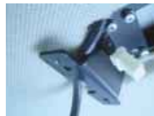
天井に対してまっすぐ付いてい るか、コネクターやモニターケ ーブルが挟まれてないか確認し ます。
